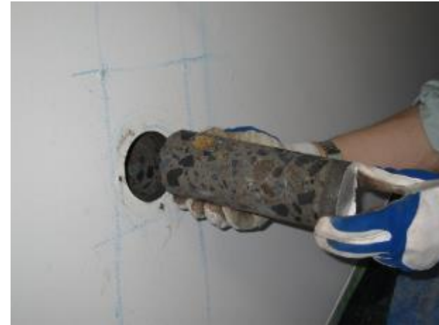
コア抜き→直接強度試験
