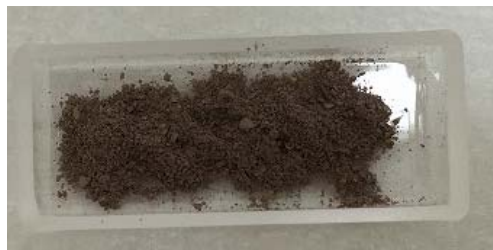
アクチノイド・FPトレーサー添加、 U-Zr-Ca-Si-O模擬燃料デブリ
