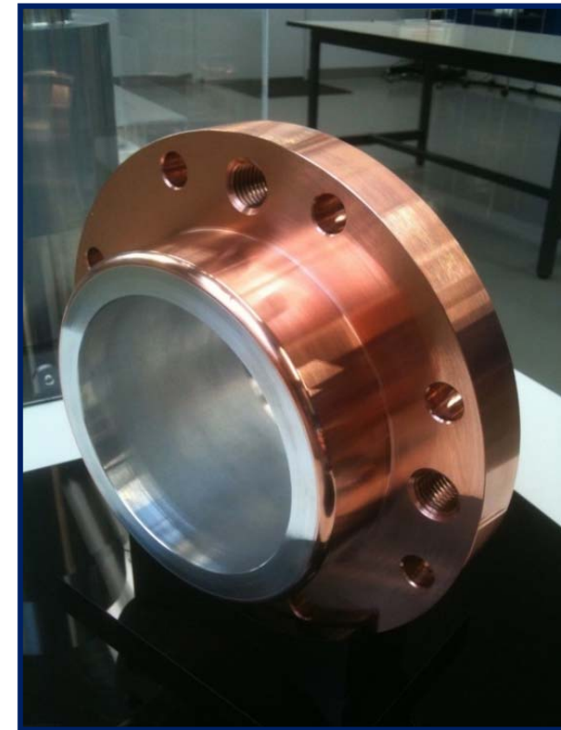
コールドスプレイで成長させた銅塊を機械加工してフランジを製作した例
