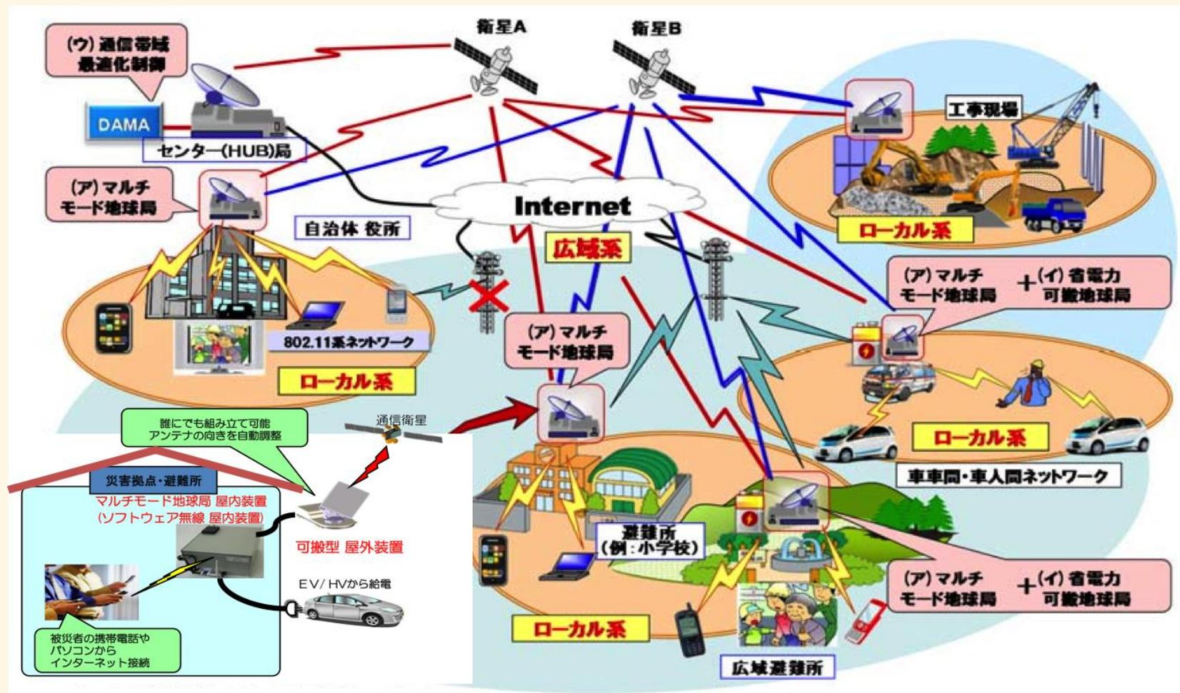
被災地のニーズに応じた衛星回線の確保のため、マルチモード地球局技術、省電力可搬地球局技術、通信帯域最適化制御技術を確立。
