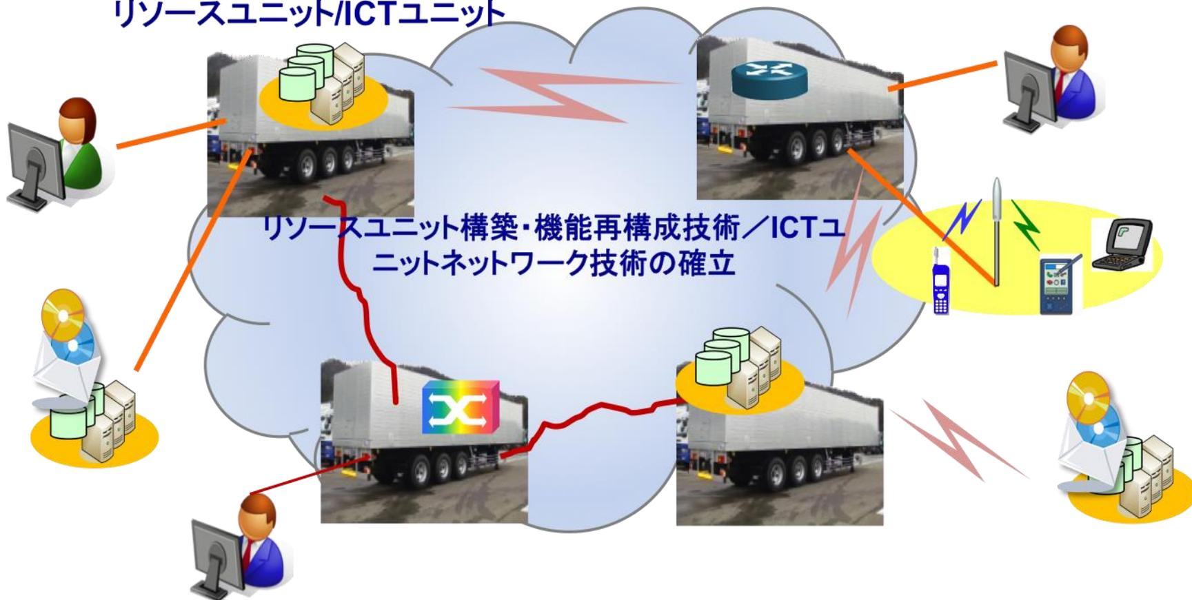
短時間に被災地へ投入し、ICTサービスの即時立上げを可能とする可搬型の情報通信基盤(リソースユニット)の研究開発を行う。数千規模のユーザ収容が可能なICTサービスをリソースユニット設置から1時間以内に提供することを目指している。
