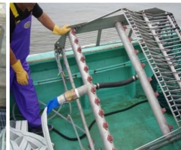
開発した噴流式貝桁網
