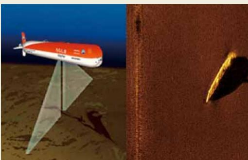
左は、サイドスキャンソナーを用いた瓦礫マッピングのイメージ。右は、津波により海底に流出した瓦礫(JAMSTEC提供)
