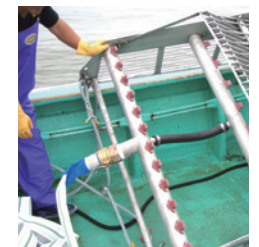
■ 実証実験で導入した噴流式貝桁網
