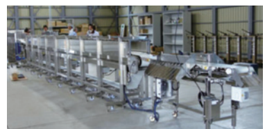
■ ベルトコンベヤー式連続個別非破壊式放射能汚染検査装置
