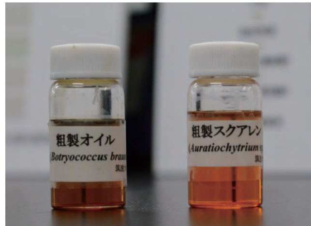
ボトリオコッカスとオーランチオキトリウムから得られた炭化水素 Hydrocarbons obtained from Aurantiochytrium and Botryococcus braunii .
