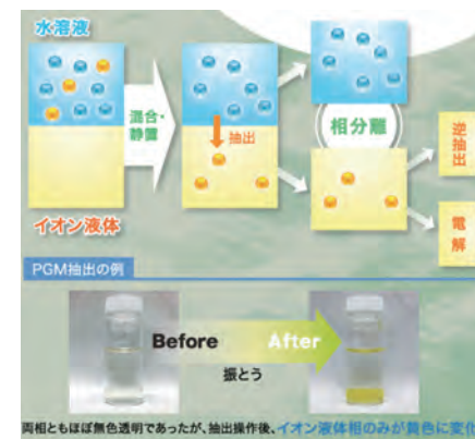
イオン液体による効率的な分離抽出 Efficient separation and extraction via ionic solutions.
