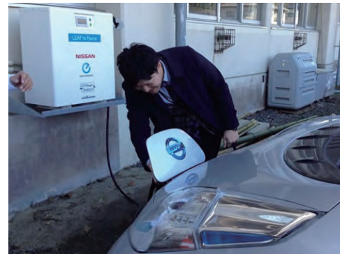
EV パワーステーション(V2H)を介した電力供給 Energy supply utilizing an electric vehicle (EV) power station (V2H).
