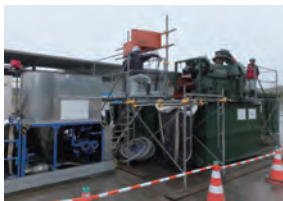
ソイルセパレータマルチ工法による津波堆積物の分級 Separation of tsunami debris by the soil separator-multi method.
