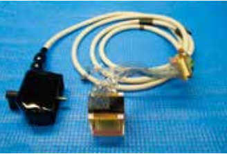
試作した2次元アレイマトリック探触子
