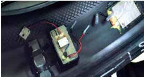
タイヤ内に装着した圧電シートと高蓄電効率電子回路
