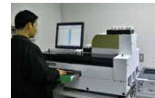
ガンマカウンターによる放射性セシウム計測の様子
