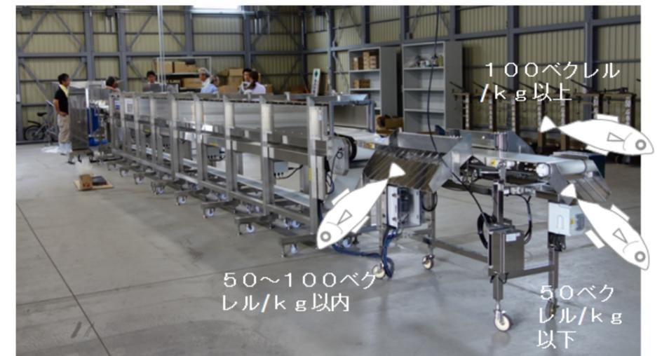
ベルトコンベヤー式連続個別非破壊汚染検査システムの設置
